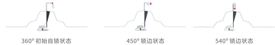
HW600多种高度和长度固定座可选 Multiple height and length clip
